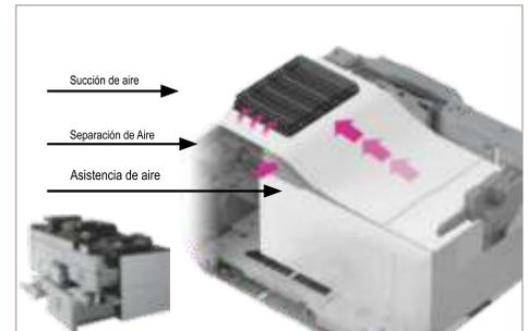
Las bandejas de alimentación de papel LCT con alimentación de aire triple maximizan la confiabilidad y minimizan el tiempo de inactividad. Los sensores neumáticos mantienen un flujo de aire consistente.
